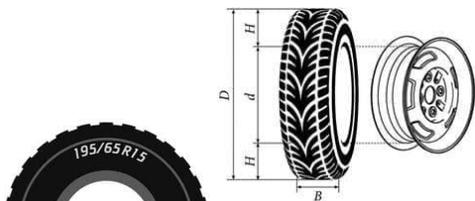
Автомобильное колесо, как правило, представляет из себя металлический диск с установленной на него резиновой шиной. Диаметр диска совпадает с диаметром внутреннего отверстия в шине.
